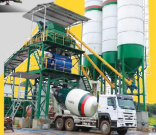
TRẠM TRỘN BÊ TÔNG VÀ XE BỒN
